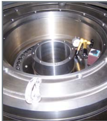
Es muss rundlaufen = 0,005mm Concentricity tolerance = 0.005 mm
